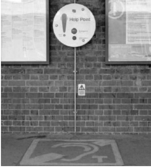
Fotograf 7. İstasyon ve terminalerde görme ve işitme engelliler için bilgi noktası düzenleme örneği (DfT, TScot, 2008)
