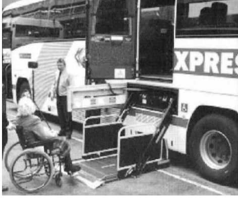
Fotoğraf 1. Kaldıraç aracılığıyla yüksek tabanlı yolcu otobüsüne erişim (ÖZİDA, 2008)
