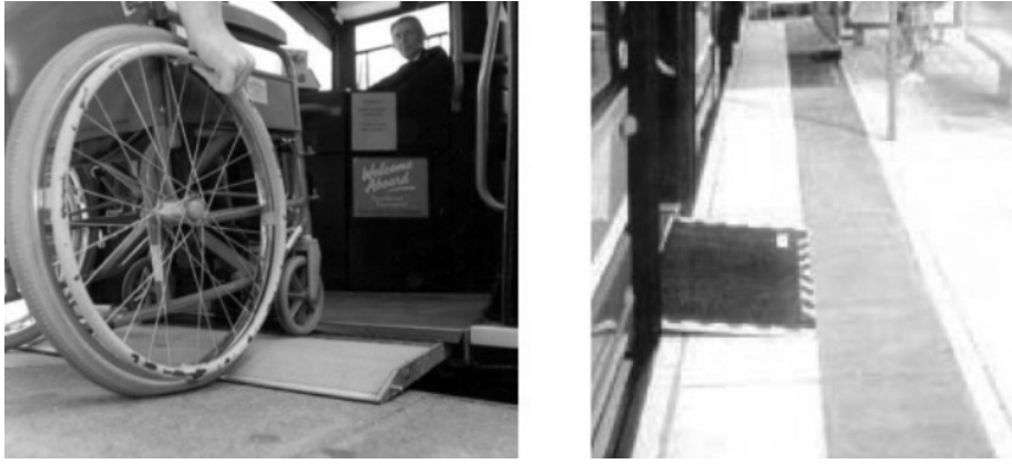
Fotoğraf 4. Basit (el kontrollü) rampa uygulama örneği (ÖZİDA, 2008)
